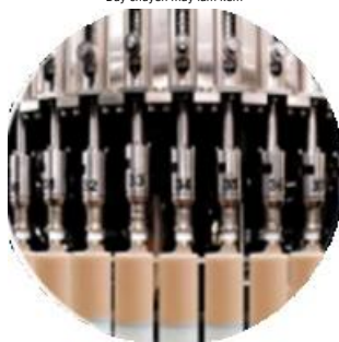
Dây chuyền máy chiết rót
